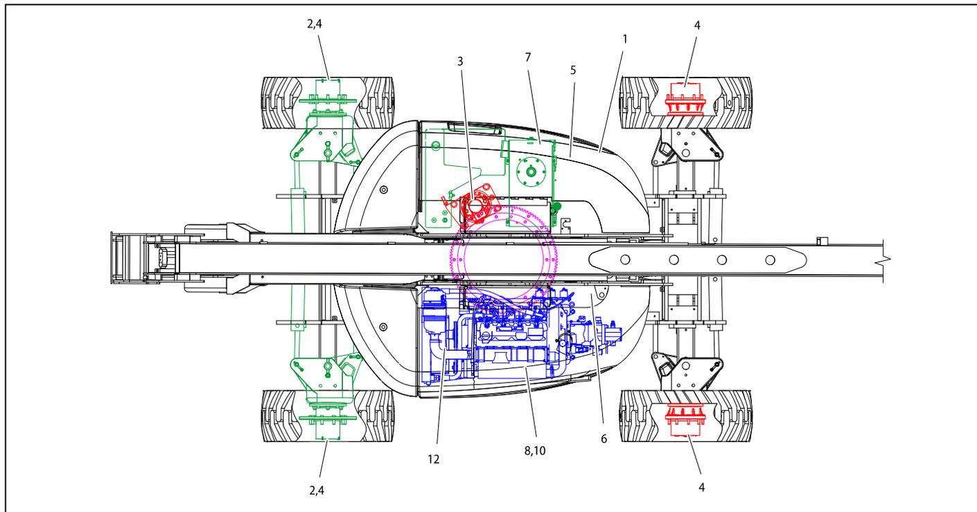
图 6-6. 操作员维护和润滑图 - Deutz D2011L04
