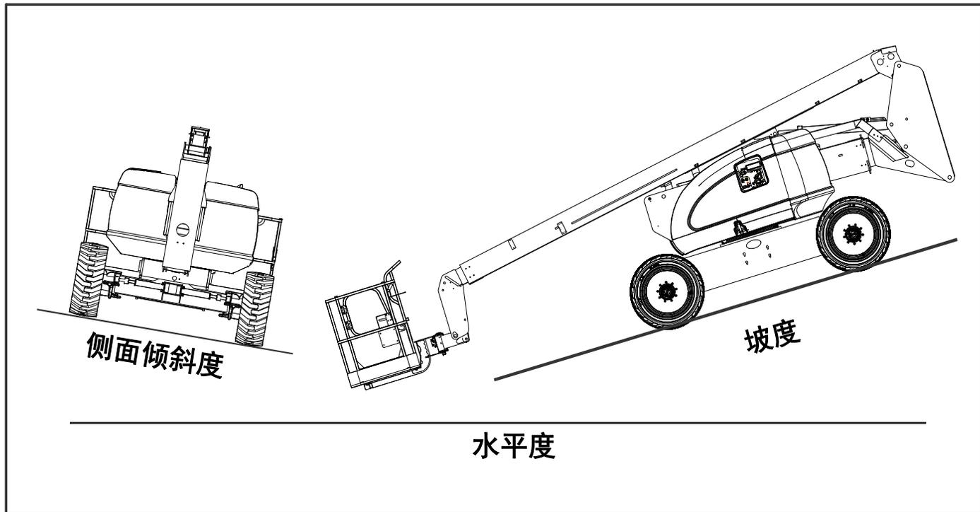
图 4-3. 正面倾斜度和侧面倾斜度
