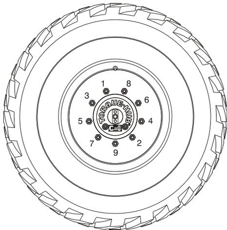
3. 必须分多次拧紧螺母。按照建议的顺序，遵循车轮扭矩表拧紧螺母。
