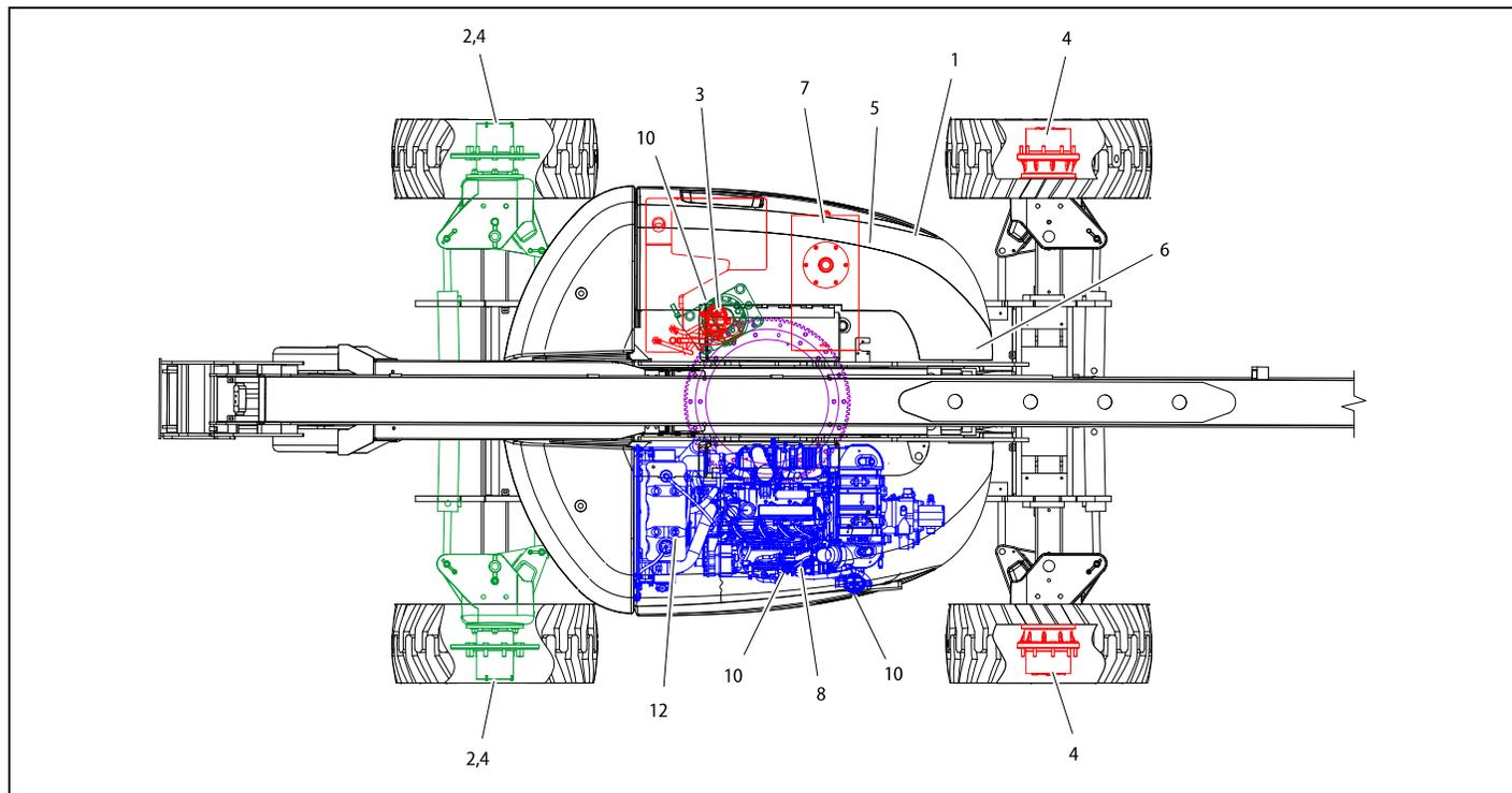
图 6-7. 操作员维护和润滑图 - Deutz TD2.9
